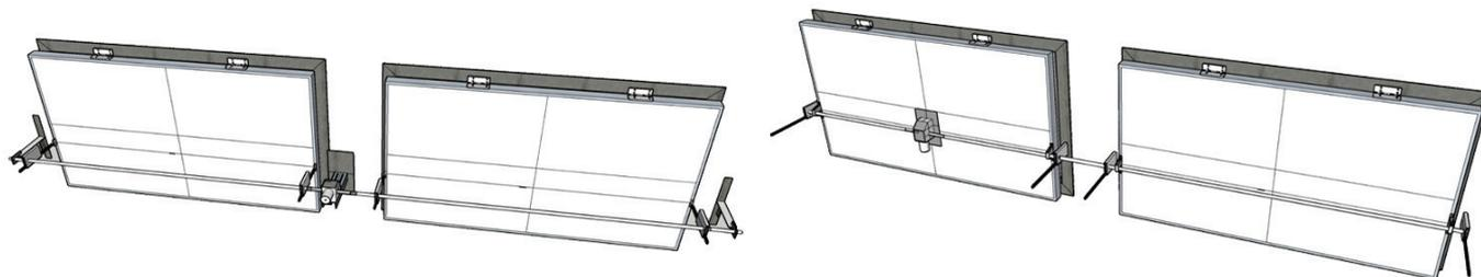
В зависимости от проектного решения и по согласованию с производителем допускается установка на один вал электродвигателя до 3-х клапанов, общим весом не превышающих 200 кг.
